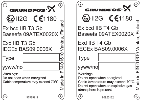
Рис. 3 Таблички для взрывозащищённых исполнений
