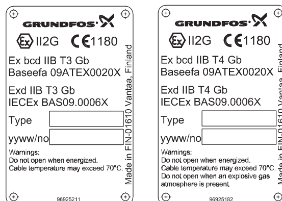
Рис. 38 Таблички для взрывозащищённых исполнений
